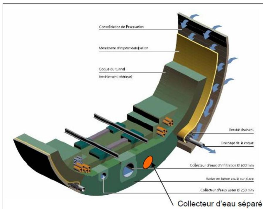
Tableau 23 : Système de drainage des eaux souterraines d'un tunnel
